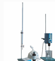
Ensemble de test au bleu de methylene
