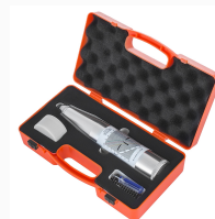
Marteau Schmidt de type N pour beton
