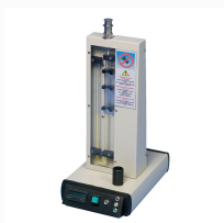
Appareil électronique de perméabilité à l'air Blaine
