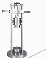
Machine d'essai de la valeur d'impact des granulats (AIV)
