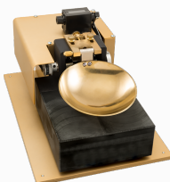
Dispositif de limite liquide Casagrande & Motorise
