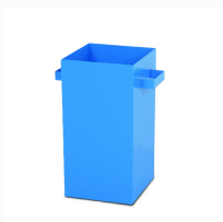
Conteneur de degre de compactabilite (Waltz)
