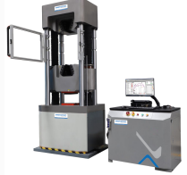
Servo Hidrolik Üniversal Test Cihazı. Çift Test Alanlı
