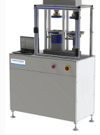
Otomatik Çimento Basma ve Etilme Denev Presleri
