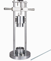
Agrega Darbe Değeri (AIV) Denev Cihazı
